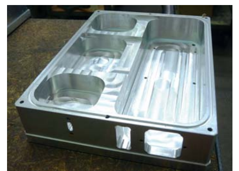
Fertiges Unterteil mit seitlichen Durchbrüchen
