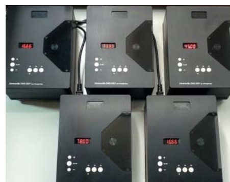
24 Stunden Dauertestlauf der ersten 5 Dereneville DMS-5001
