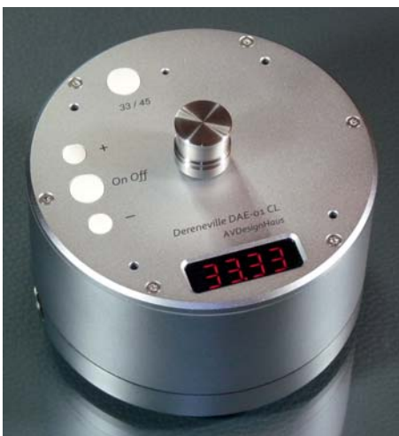
Fertige DAE-01 CL beim 24 Std. Testlauf.
