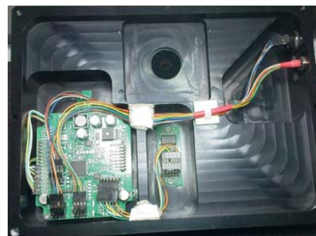
Einbau des „Gehirns“ die Steuerelektronik
